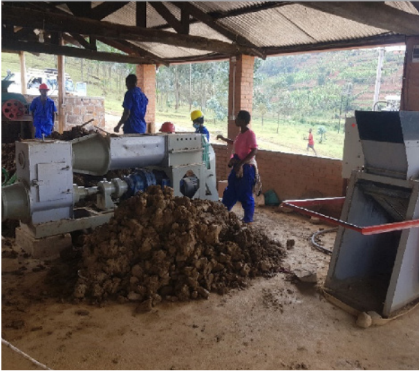
Une petite ligne de production se compose d'un broyeur et d'une extrudeuse motorisée avec pompe à vide.
