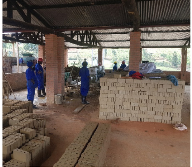
De grands hangars sont utilisés pour stocker les produits avant la cuisson. Les hangars sont conçus pour permettre un flux d'air suffisant afin de sécher uniformément les produits.
