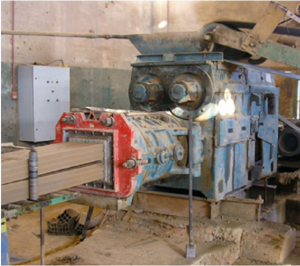
L'extrudeuse mécanisée à haute capacité permet l'extrusion simultanée de plusieurs produits.
