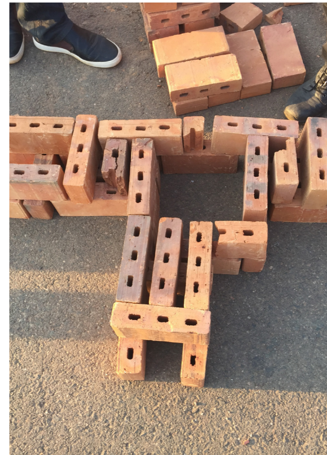
Pile sèche d'un échantillon de mur RLB
